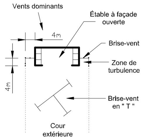
Lors de l'érection d'une nouvelle étable à façade ouverte avec cour extérieure, prévoir une distance de 20 mètres d'une bâtisse existante afin d'éviter l'effet "tunnel" et l'augmentation de la turbulence entre les deux bâtiments.
